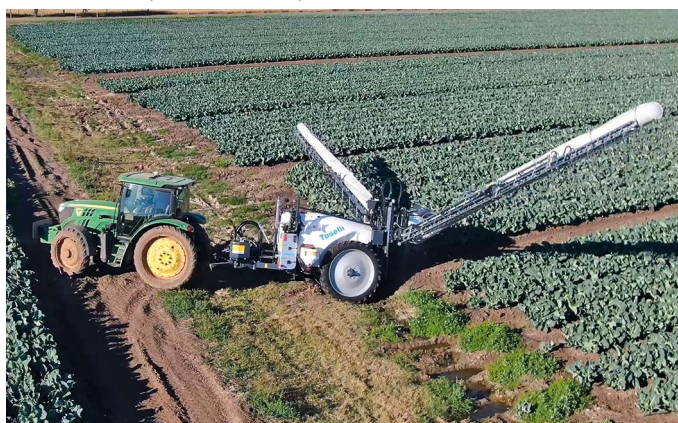
Cloud 3000 con carreggiata stretta (mm. 1500) assicura massima stabilità e sicurezza anche nelle condizioni più avverse Cloud 3000 with narrow wheeltrack (mm. 1500) provides maximum safety and stability even in most adverse conditions
