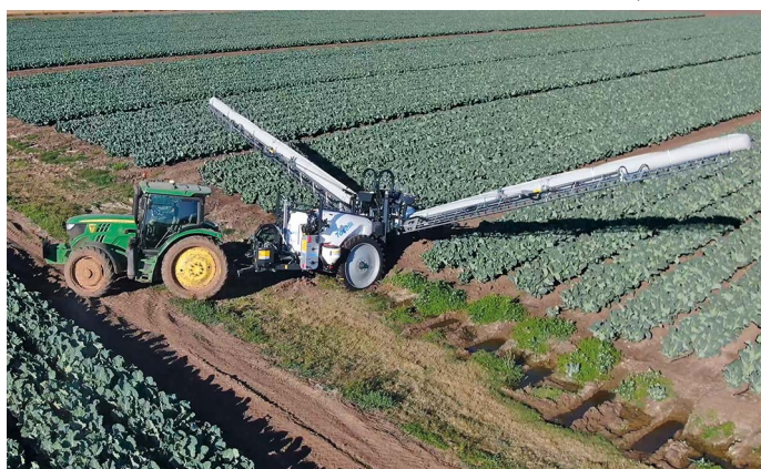
Cloud 3000 con carreggiata stretta (mm. 1500) assicura massima stabilità e sicurezza anche nelle condizioni più avverse Cloud 3000 with narrow wheeltrack (mm. 1500) provides maximum safety and stability even in most adverse conditions
